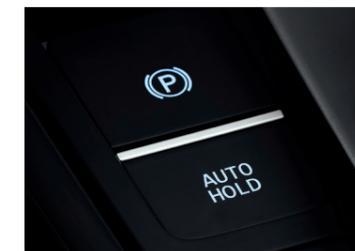
Freno de estacionamiento eléctrico con retención automática
